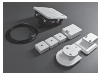
【バイタル測定装置の試作機】
